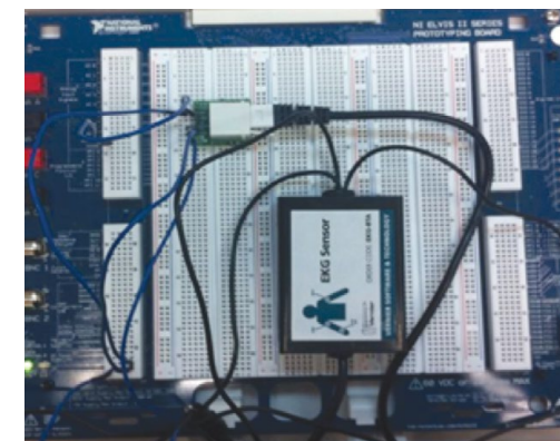
Figura 6. Conexiones a la tarjeta Elvis II con el sensor EKG y el Analog Protoboard Connector.
